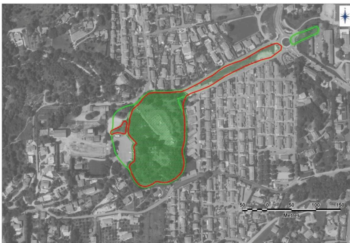
**Figure 7 : Révision de l'emprise du terril du puits Hely d'Oissel et de l'aléa tassement de niveau faible associé sur la commune de Greasque (fond BD ORTHO® IGN 2011)**
