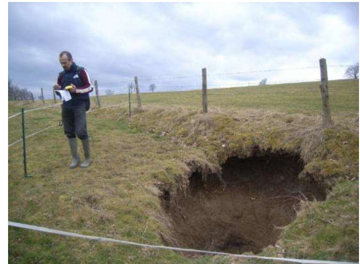
Effondrement localisé, mine de charbon, concession de Bert, 03 19
