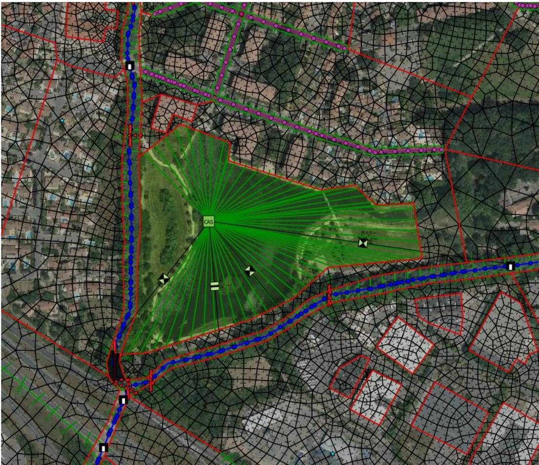
Figure 26 : Bassin de La Tuilière à Vitrolles représenté par un casier avec un niveau d'eau imposé à l'état initial
